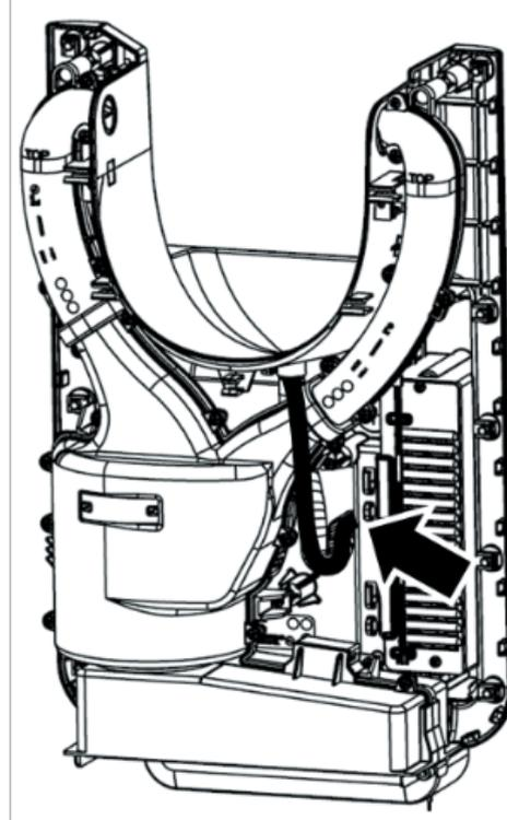
Collegare il tubo fornito con la macchina allo scarico dell'acqua sul retro della macchina. Montare la macchina a muro tenendo presente che il tubo montato sulla macchina deve entrare nello scarico a muro.
